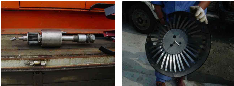
<그림 3-2> Drag Trowel 라이닝 장치 (좌 : 세라믹모르터 분사헤드, 우 : 미장용 인두)
