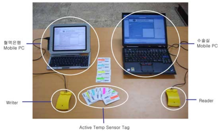
(그림 5-13) 혈액백 관리 시스템 구성도
