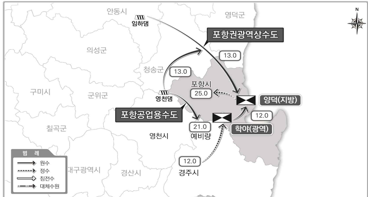
〈그림 5.7-c〉 포항광역 및 공업 급수체계조정 모식도
