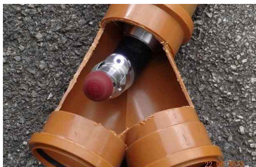
<그림 7> 로봇 보수(Robotic Repair)를 활용한 시공 예시
