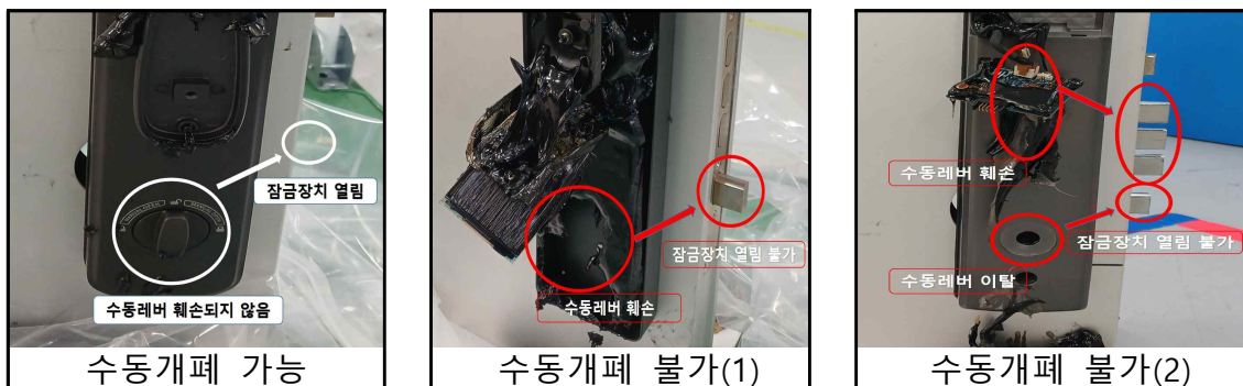
<그림1> ‘화재 시 열림(대비)’ 시험평가 결과
