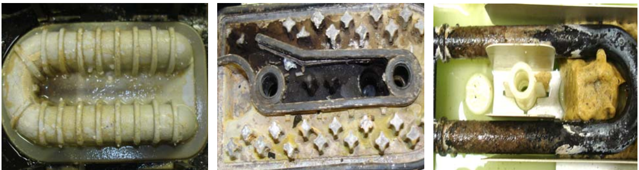
<히터 표면 부식, 물탱크 내부에 발생한 물때나 이물질>
