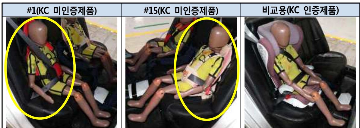
【그림 4-4】 시험대상 어린이보호장치 더미 착좌 모습
